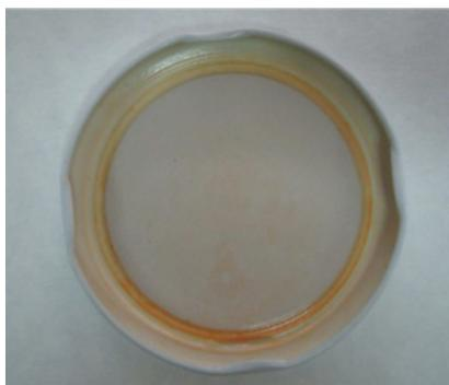
Figura 14. Tapa con huella circular y continua, impresa en el recubrimiento o Plastisol (Bacteriological Analytical Manual (BAM) Chapter 22B: Examination of Glass Containers for Integrity).
