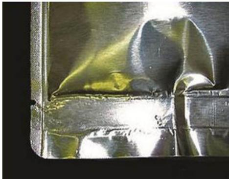
Figura 5. Pliegue en caliente.
